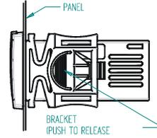
XR06CX cihazı dik bir panoya, 29x71mm ebatlarında bir yuvaya, tedarik edilen özel klipslerle monte edilmelidir. Cihazın doğru çalışması için izin verilen sıcaklık aralığı 0+60 °C 'dir. Cihazı titreşimli, zararlı gazlı, kirlili ve aşırı nemli ortamlardan uzak tutun. Aynı tavsiyeler sensörler için de geçerlidir. Havanın soğutma deliklerinden sirkülasyonuna izin verilir.
