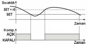
Termostat probunda bir hata olması halinde kompresörün start ve stop butonları "Cy" ve "Cn" parametreleri ile zamanlanır.
